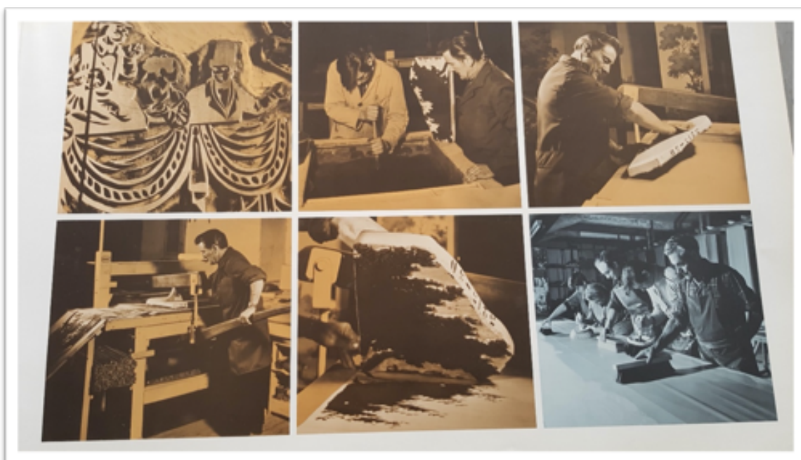
Der Druckvorgang und rechts Unten das Grundieren der Tapetenbahn.
